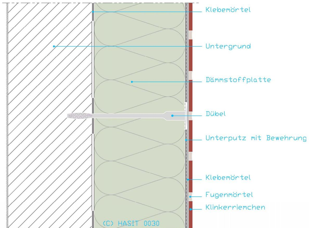
**Aufbau des WDVS mit Mineralwolle-Dämmstoff
