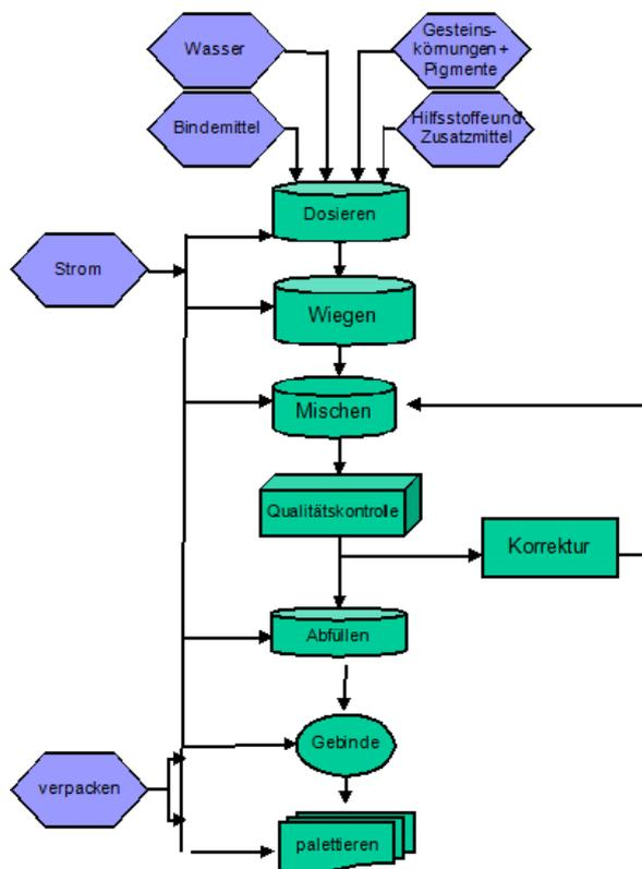
Die Rohstoffe werden im Herstellwerk in Silos, Big Bags, Fässern oder Säcken gelagert. Entsprechend der jeweiligen Rezeptur werden sie gravimetrisch dosiert und intensiv vermischt. Nach der Abfüllung und Verpackung werden sie ggf. getönt, zwischengelagert oder direkt ausgeliefert. Auf der Baustelle besteht die Möglichkeit, die Konsistenz der Produkte den Anwendungs- und Wetterbedingungen mit Wasser anzupassen.
